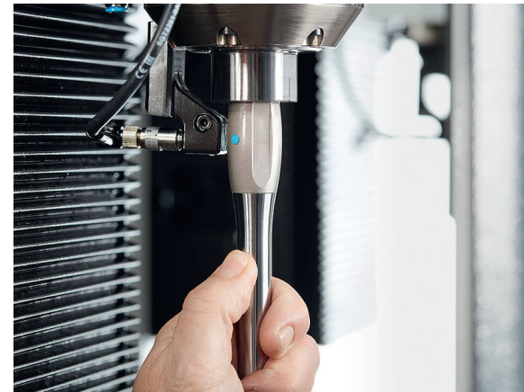
Beim Einbau der Honwerkzeuge in die Spindel werden alle Informationen sekundenschnell an die Steuerung übermittelt. Eine eindeutige Identifikation ist auf diese Weise sichergestellt © Neosid
